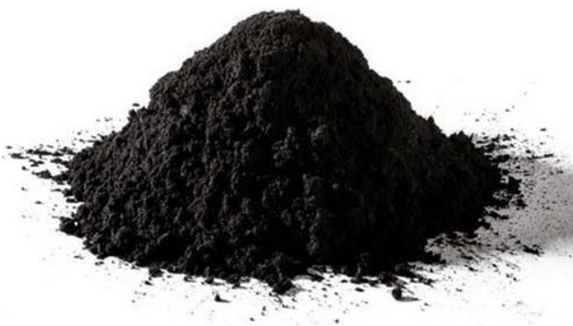
Рис. 2.5. Загальний вид технічного вуглецю (нанодисперсної пігментної сажі) CARBON BLACK марки PowCarbon 2419G
