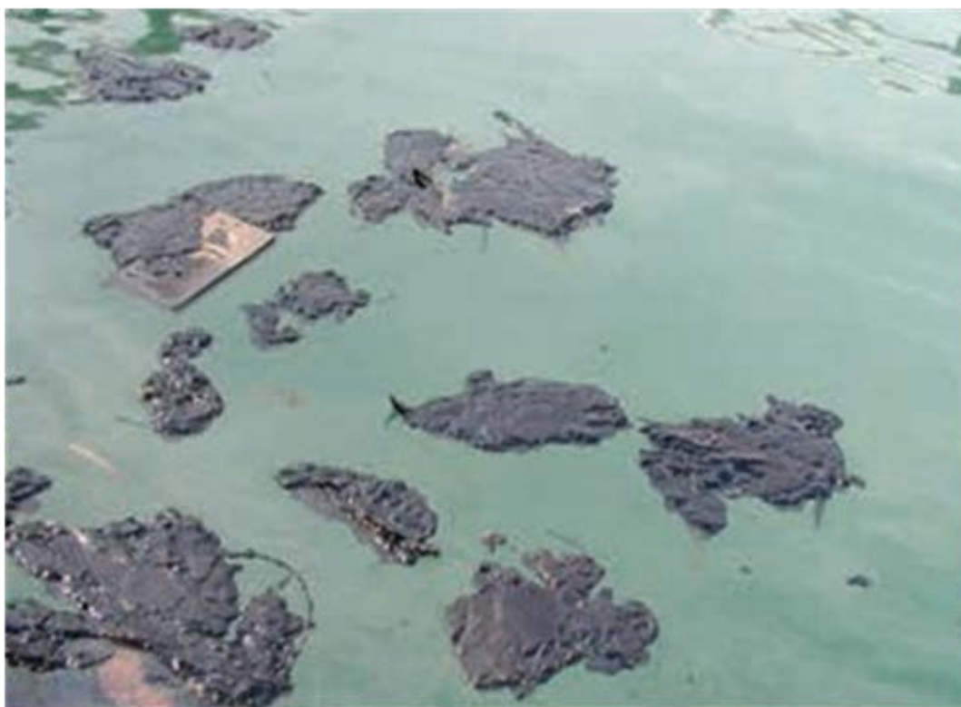
Рис. 2 Нафта, розлита в морі при температурі нижче температури застигання, утворює напівтверді фрагменти
